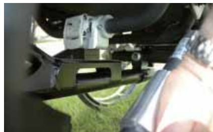
Aufnahme des Rahmenadapters am Achsrohr: Optisch elegant, aber für Tetraplegiker schlecht zu greifen
