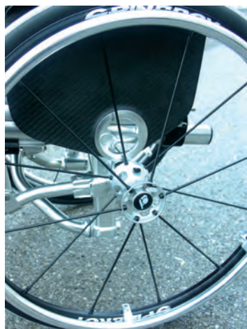
Schick: Die Exzentereinheit ermöglicht es, die Seitenteile schnell und individuell einzustellen
