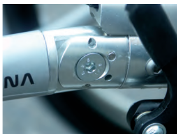
Ungenau: Beim Gelenk für die Einstellung des vorderen Rahmens passen die Bohrungen nicht genau übereinander
