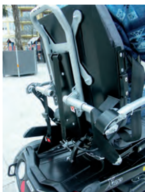
Durchdacht: Der Gurt (Bildmitte) sorgt für den Längenausgleich beim Aufrichtevorgang
